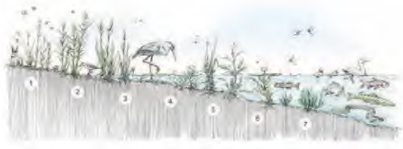
Figuur 6.8 Schema van een natuurvriendelijke oever met verschillende zones (bron: Stowa)
